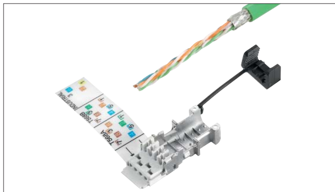
1. Снимите оболочку и укоротите экран до 5 мм
